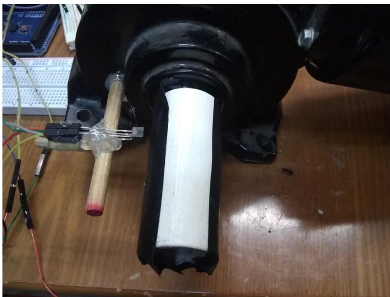
Figura 54. Sensor QRD1114 acoplado al eje del motor
