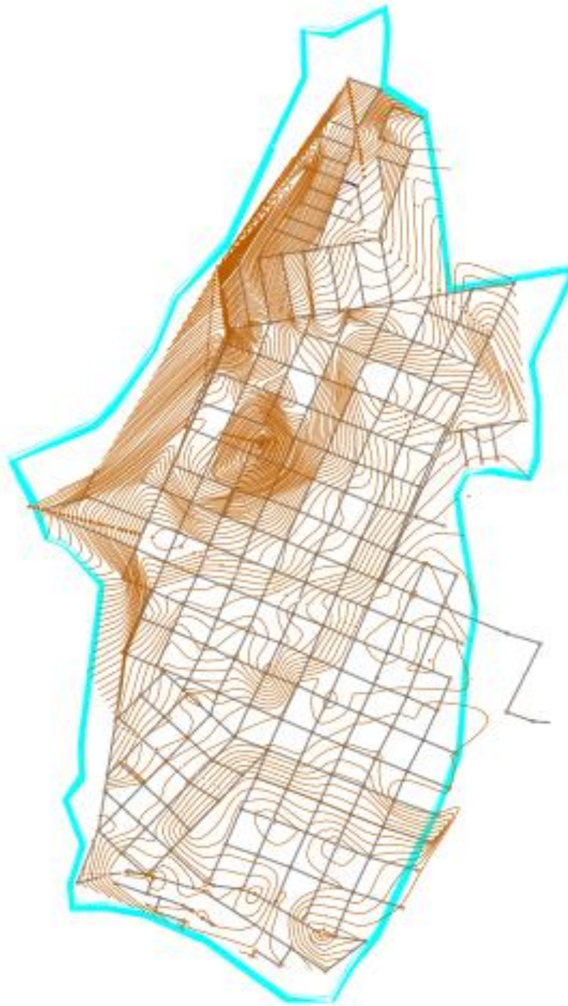
Figura 33. Curvas de nivel de zona centro obtenidas del levantamiento topográfico realizado en campo. Fuente: Elaboración propia
