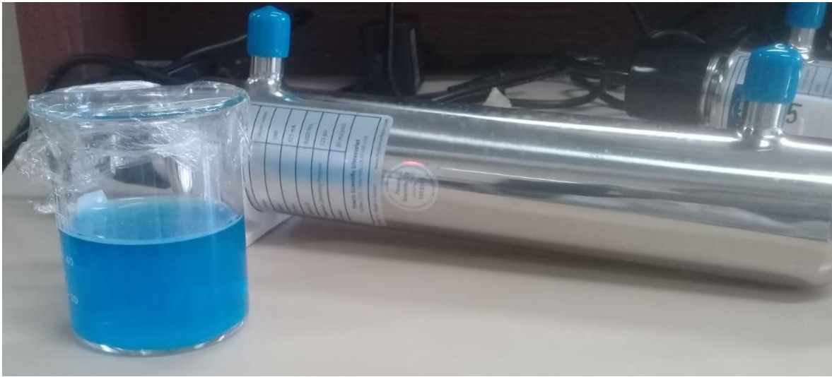
Figura 13. Solución de azul de metileno con ZnO en lámpara de luz UV.
