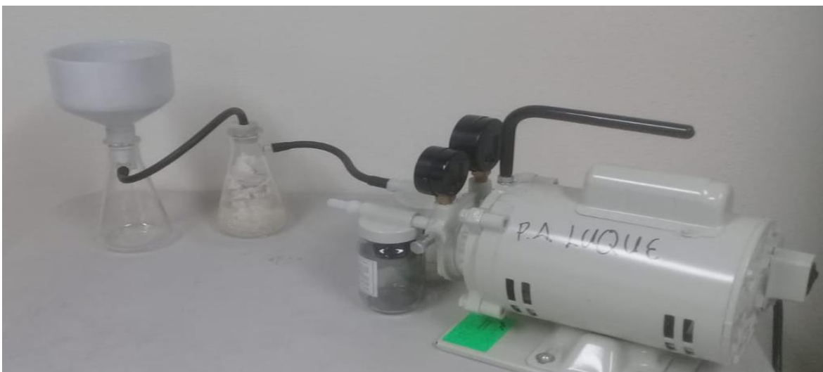
Figura 8. Equipo utilizado en la filtración del extracto de Arnica montana L.
