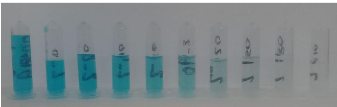
Figura 22. Decoloración de azul de metileno por medio de fotocátalisis usando nanopartículas de ZnO.
