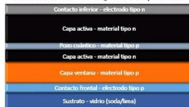
Fig. (2). Estructura de una celda solar unitaria de heterounión pn con la inserción de un QW en la capa activa.
