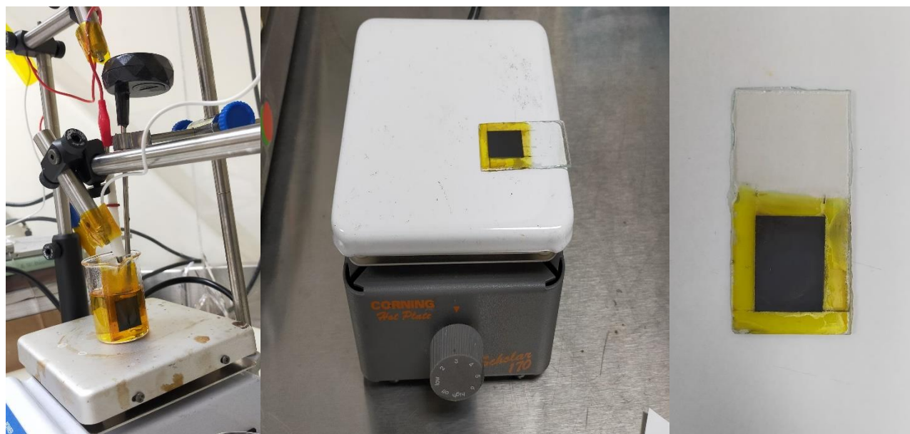
Figura 4.1.2.2. Electrodeposición de CdTe/HgCdTe/CdTe: a) Estructura sumergida en la solución electrolítica; b) Tratamiento térmico post-electrodeposición; c) Sustrato con las películas electrodepositadas de CdTe/CdHgTe/CdTe
