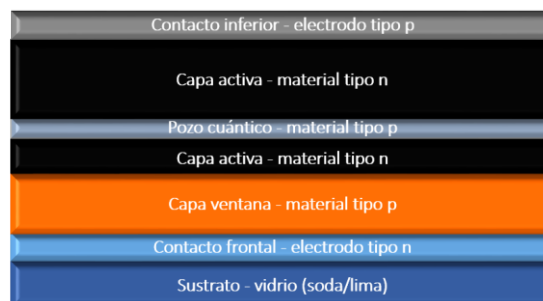
Figura 3.2.1.1. Estructura de una celda solar formada con heterounión pn con inserción de un Qw.
