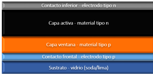
Figura 3.1.1.1. Estructura de una celda solar formada con heterounión pn.
