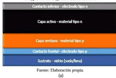
Fig. (1). Celda solar unitaria de heterounión PN. (a) estructura; (b) diagrama energético de la unión.
