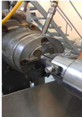
Figura 5. Cabezal del extrusor con matriz de salida y cuchillas de corte
