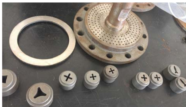
Figura 1. Matriz de salida del extrusor con diferentes insertos o moldes que permiten la producción de una gran variedad de alimentos.
