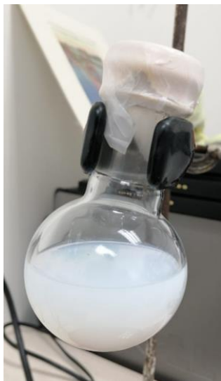
Figura 9. Nanogeles CAM10 1%/EGDMA 5%/ DBS 1%/ APS 2% obtenidos por polimerización en emulsión.
