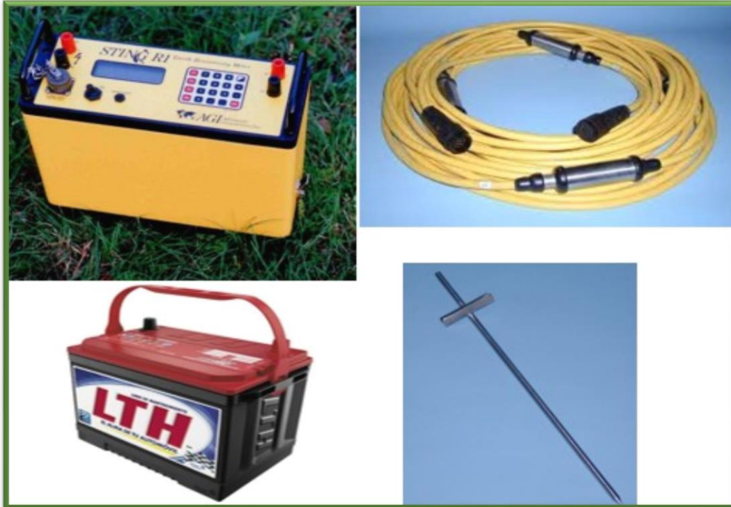
Figura 15. Equipo de medición SuperSting, a) Consola programable; b) cables y electrodos inteligentes; c) fuente de poder (batería); d) varillas.
