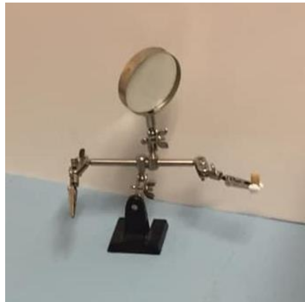
Figura 1. Se observa tixtura con gancho envuelto de teflón y el diente detenido.
