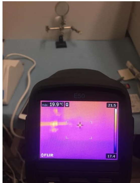
Figura 5. Cámara de termografía infrarroja utilizada, se observa la toma de la temperatura inicial.
