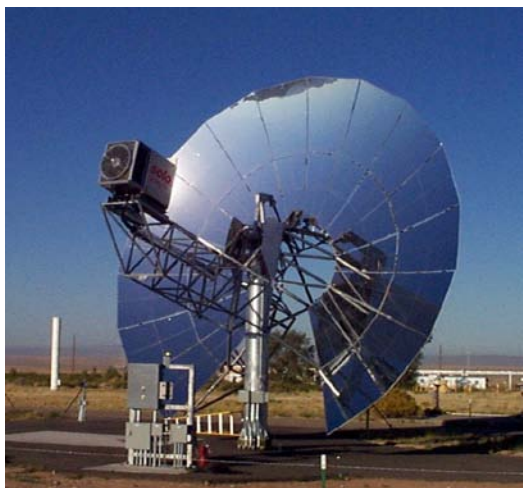
Figura 1.5. Sistema ADDS para operación remota.
