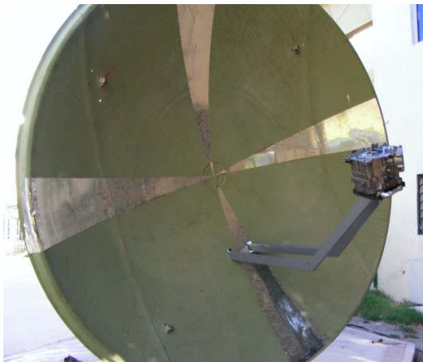
Figura 4.1. Concentrador solar de fibra de vidrio de 3.2 m.
