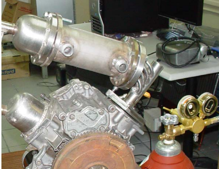
Figura 4.9. Vista del enfriador de tubo y coraza.
