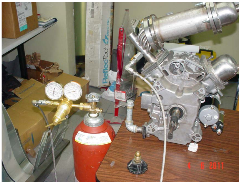
Figura 4.10. Montaje del sistema de carga de gas del motor.
