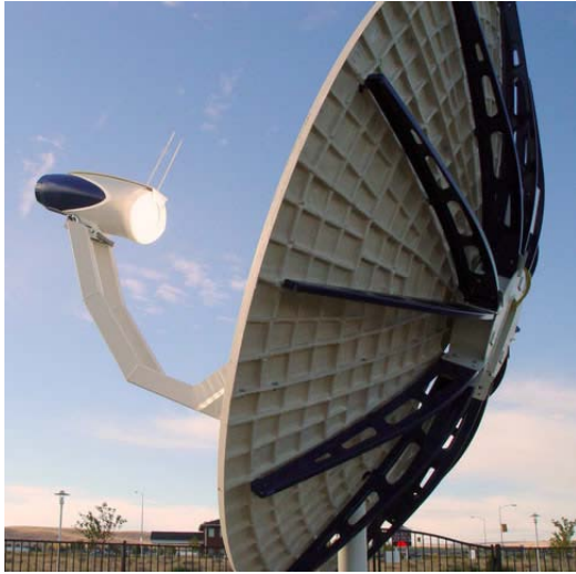
Figura 1.7. Sistema PowerDish producido por Infinia Corp.
