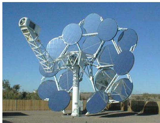
Figura 1.4. Sistema SAIC/STM de 25 kW instalado en Phoenix, Arizona.
