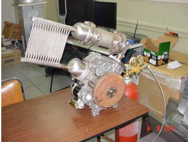
Figura 4.11. Vista del motor con el sistema de arranque.
