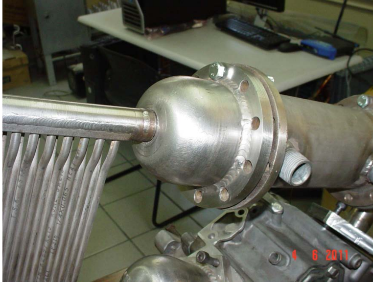
Figura 4.7. Vista del regenerador.
