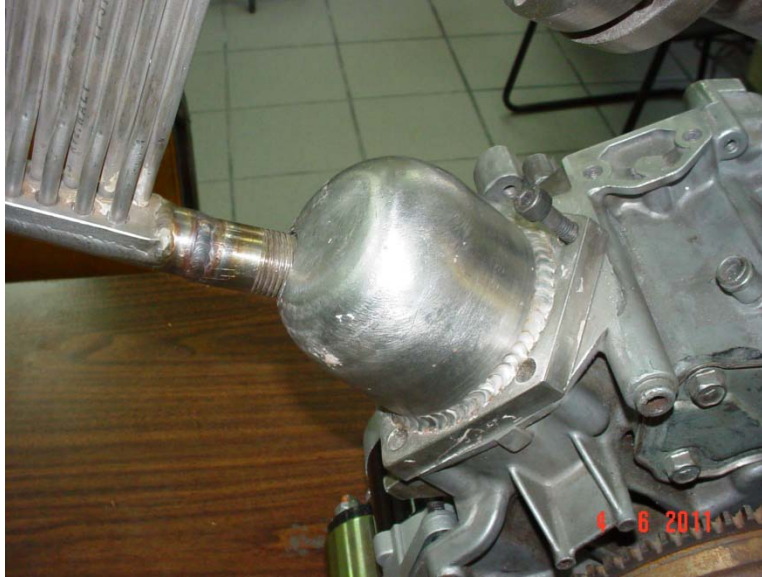
Figura 4.5. Vista de la extensión del cilindro (contenedor del desplazador).
