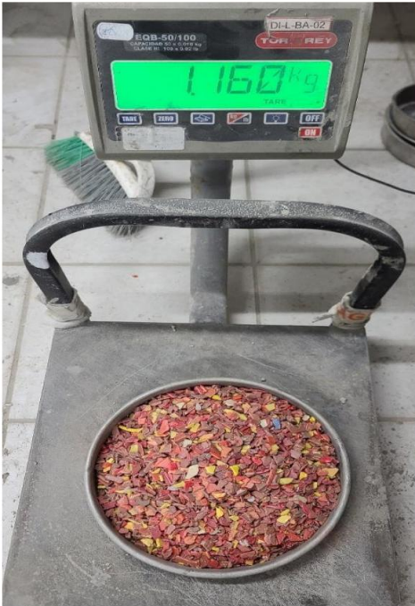
Ilustración 21. Dosificación de HDPE para un reemplazo del 30% y Materiales naturales y reemplazo del 30% en revolvedora
