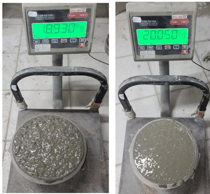
Ilustración 23 Peso del concreto y del recipiente. MT-4 y Peso del concreto y del recipiente de la MR30-1
