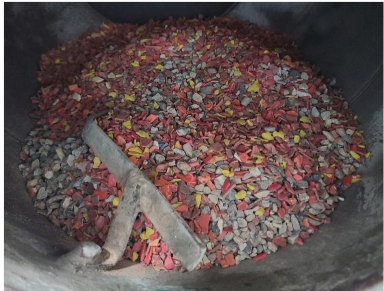
Ilustración 21. Dosificación de HDPE para un reemplazo del 30% y Materiales naturales y reemplazo del 30% en revolvedora
