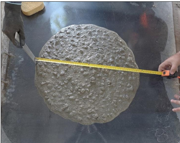
Ilustración 3. Prueba de extensibilidad en concreto Autocompactable (consistencia fluida viscosa). Prueba de revenimiento (Cono de Abrahams) en concreto convencional (consistencia plástica a semi fluida) Fuente: Elaboración propia.
