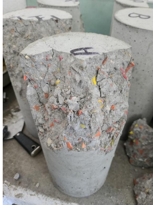
Ilustración 24. Pares de cilindros de 15x30cm de distintos reemplazos para medir resistencia a la compresión. Izquierda: Cilindro de MR30 después del ensaye a compresión, Derecha: 2 Cilindro de MT-4 después del ensaye de compresión.
