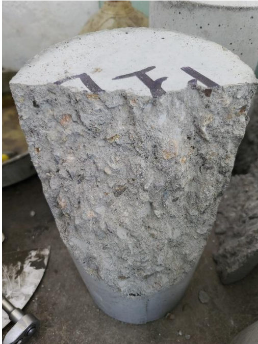
Ilustración 24. Pares de cilindros de 15x30cm de distintos reemplazos para medir resistencia a la compresión. Izquierda: Cilindro de MR30 después del ensaye a compresión, Derecha: 2 Cilindro de MT-4 después del ensaye de compresión.
