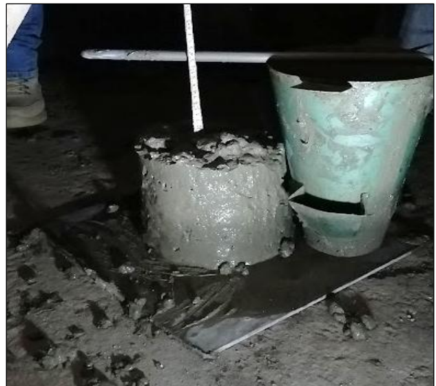
Ilustración 3. Prueba de extensibilidad en concreto Autocompactable (consistencia fluida viscosa). Prueba de revenimiento (Cono de Abrahams) en concreto convencional (consistencia plástica a semi fluida) Fuente: Elaboración propia.
