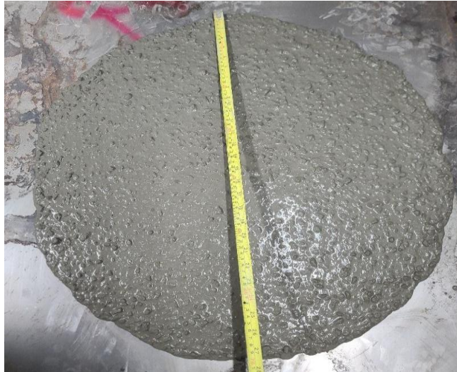
Ilustración 20. Extensibilidad de la MT-4. VSI = 0, Extensibilidad 77cm
