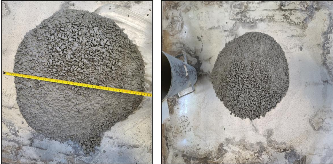
Ilustración 19. Izquierda: Extendido de MT-2. Con poco flujo y acumulación de agregado grueso. VSI = 3. Derecha: Extendido de MT-1. Con poco o nulo flujo y acumulación del agregado grueso VSI = 3.
