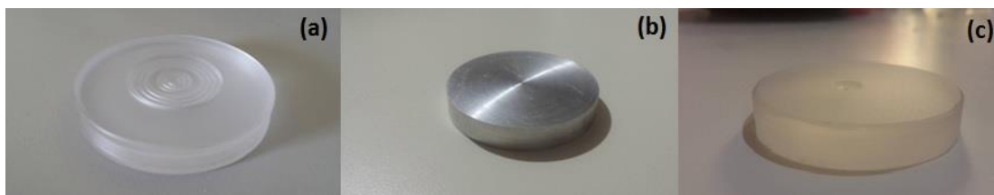
Figura 24. Portamuestras de (a) Bruker, (b) aluminio, y (c) vidrio.
