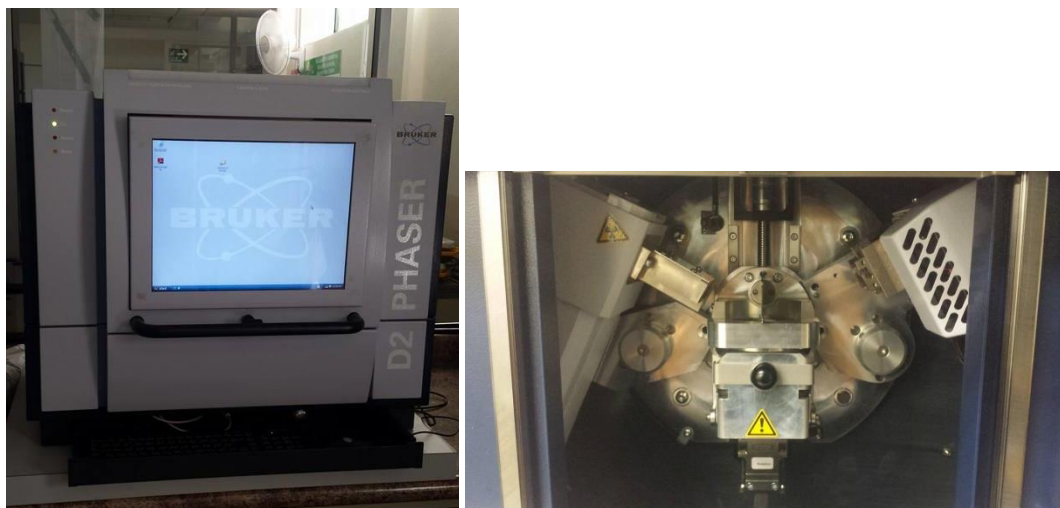
Figura 1. Difractómetro D2 PHASER Bruker, vista externa e interna, respectivamente.
