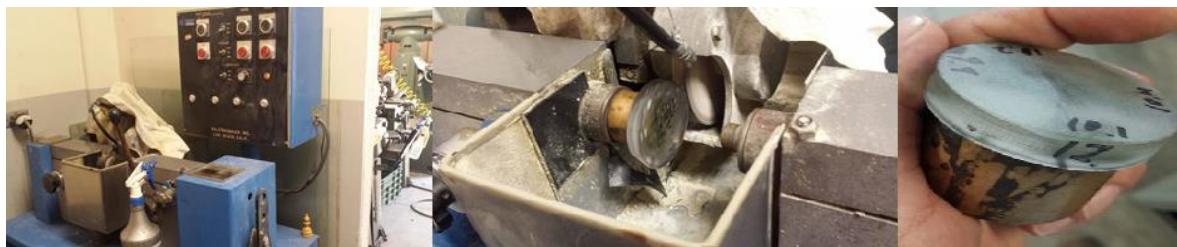
Figura 22. Esmerilado del portamuestras de vidrio.
