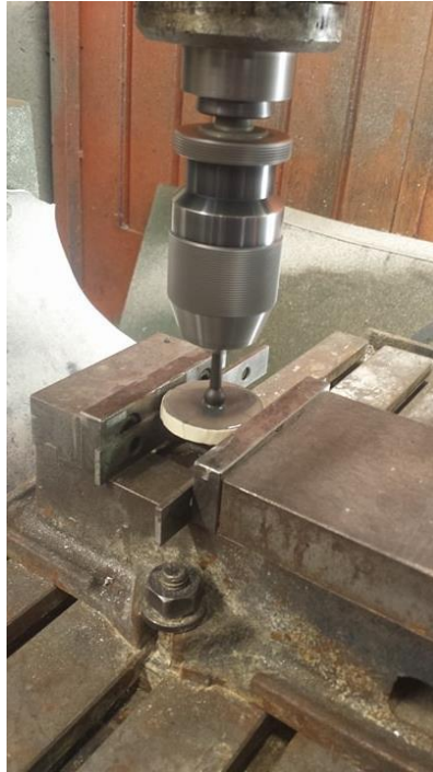
Figura 23. Generación de la concavidad en el portamuestras de vidrio a partir del uso de la fresadora.
