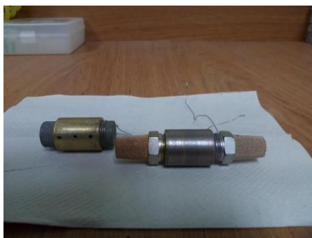
Figura 15. Cápsula de acero inoxidable y filtro de latón de 60 y 180 \mu\text{m} de tamaño de poro.
