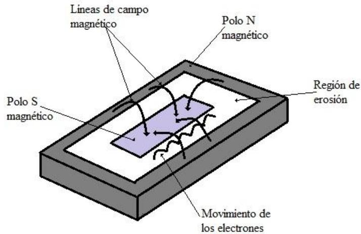
**Figura 2.1.1.3.-** Líneas del campo magnético generado por el arreglo de imanes[2].
