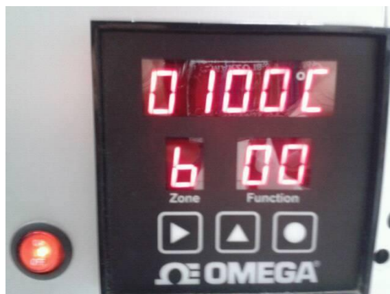
Figura 10. Controlador OMEGA CN616TC1, controlando la zona 6 a 100 °C
