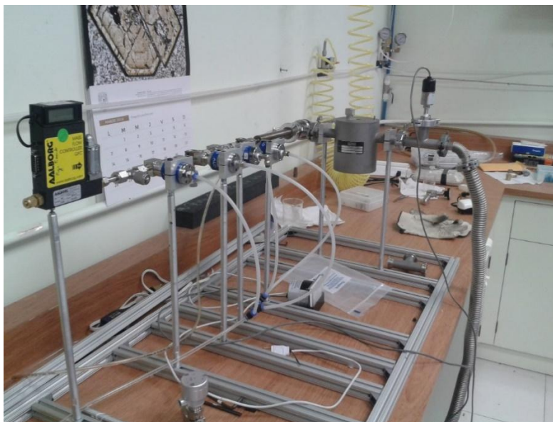
Figura 9. Sistema ALD en proceso de construcción y los principales componentes del múltiple de admisión.
