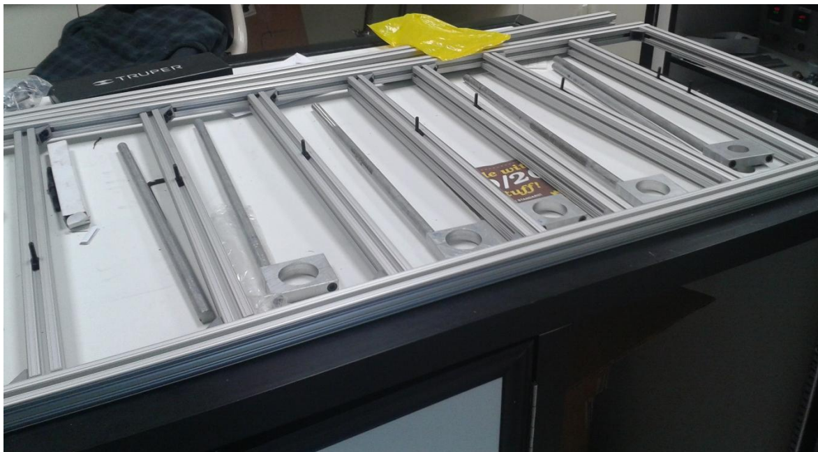
Figura 8. Base del sistema ALD construido en su mayoría por productos de la compañía 80/20 inc.
