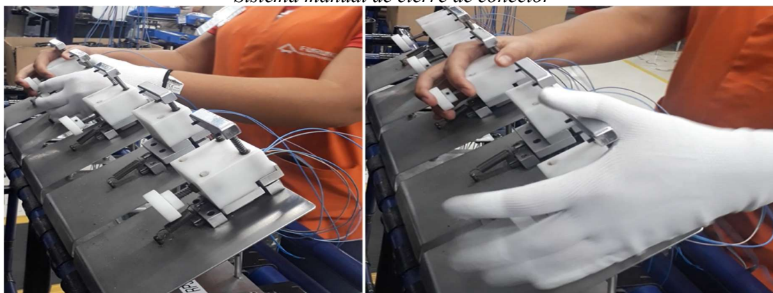
Figura 5.17 Sistema manual de cierre de conector
