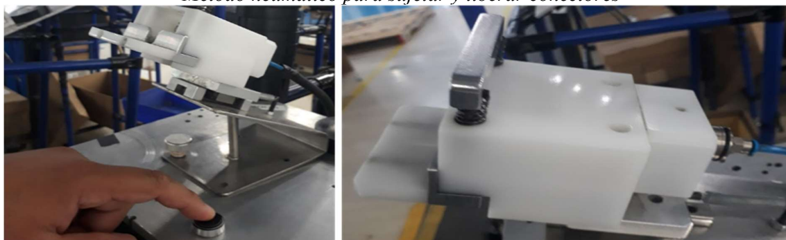
Figura 5.14 Método neumático para sujetar y liberar conectores
