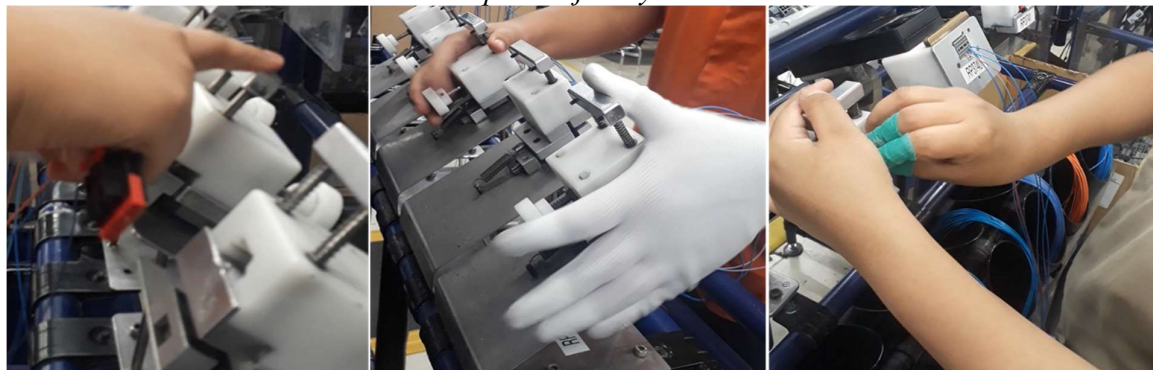
Figura 5.13 Método manual para sujetar y liberar conectores
