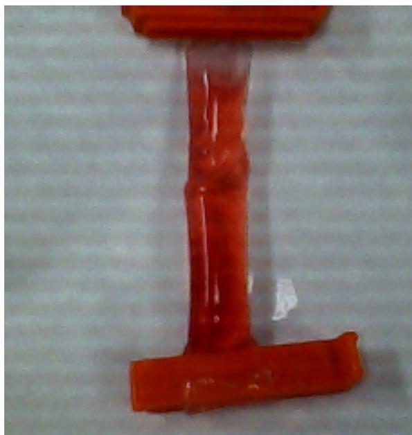
Figura 58. DOX incorporada en los nanogeles de composición NIPAAm/PE GMAM/EGDMA<sub>5%mol</sub>/MAOB<sub>15%mol</sub> después de la liberación a 36 hrs.
