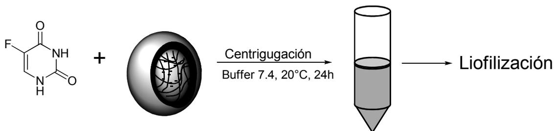
Figura 14. Diagrama de flujo para el cargado de los nanogeles con 5-Fluorouracilo.
