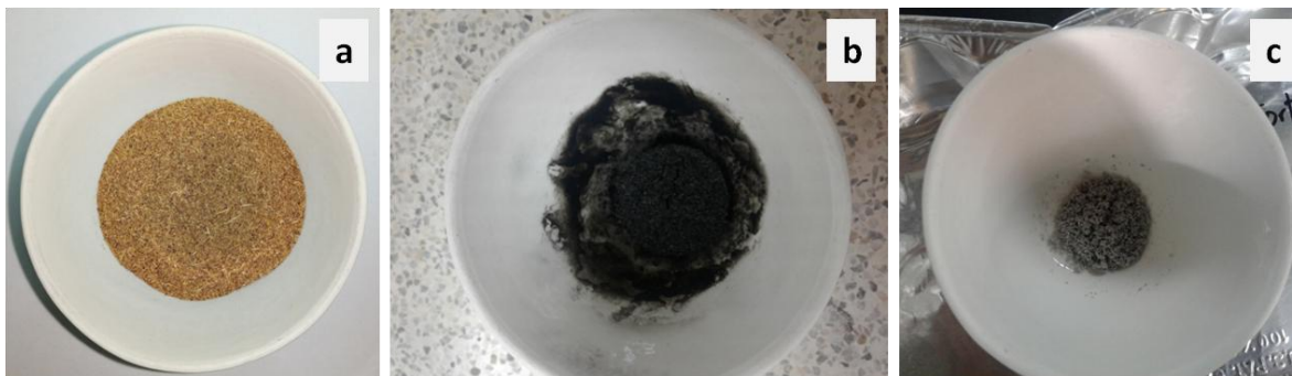
Figura 17. Análisis próximo a) bagazo sin humedad, b) bagazo sin materia volátil, c) cenizas. Fuente: elaboración propia
