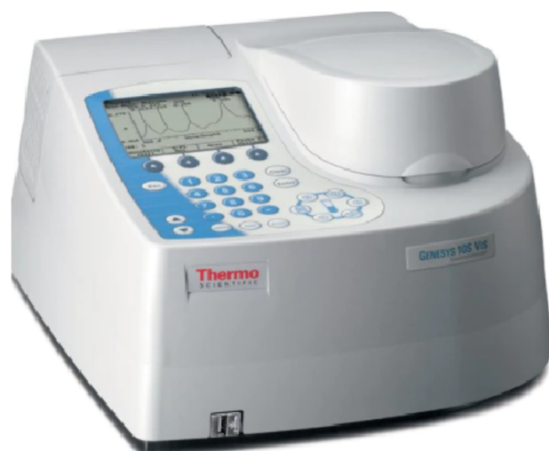
Figura 7. Espectrofotómetro UV-Vis Thermo Scientific GENESYS 10S Vis utilizado para la caracterización óptica de las nanopartículas de plata.
