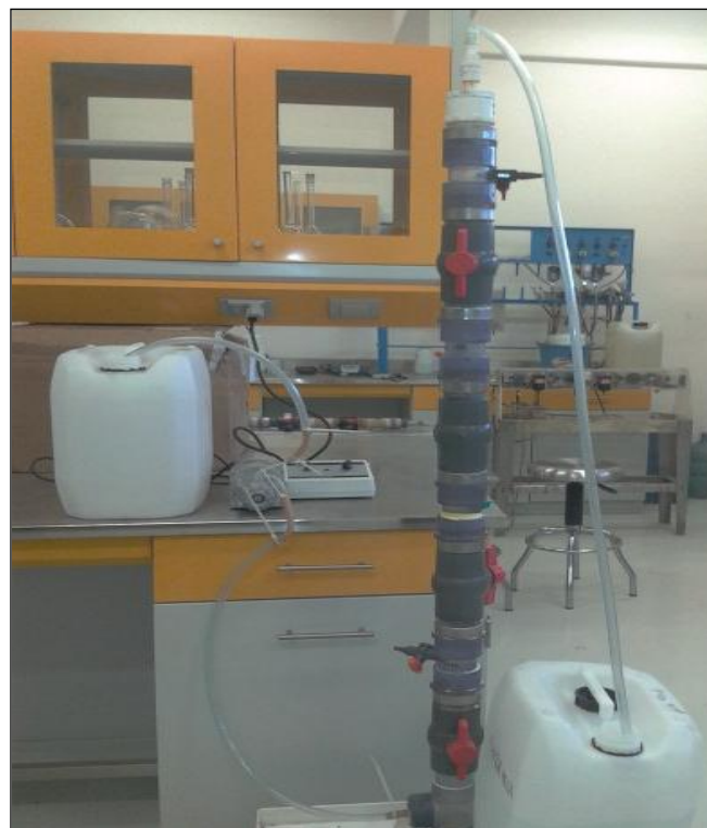
Figura 2. Columna de lecho fijo, empacada con zeolita pre-tratada.
