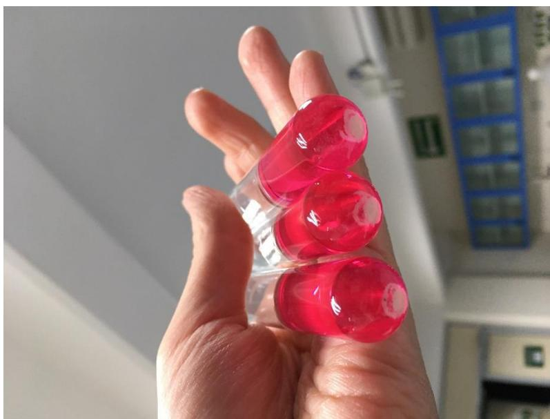
Figura 10: Nanopartículas metálicas de ZnO en EtOH al 0.1 % tras someterse a un periodo de agitación de 30 min a 185 rpm.
