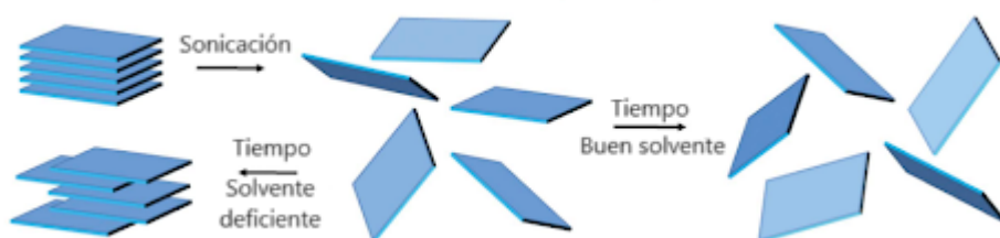
Figura 7. Esquema del papel del solvente en la exfoliación líquida [7].
