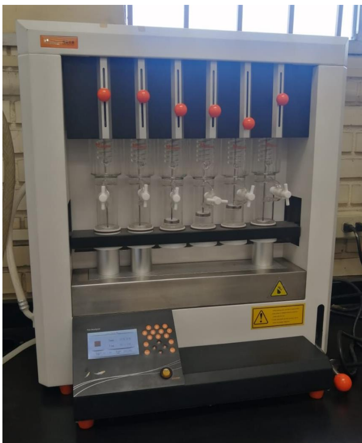
FIGURA. 16. EQUIPO PARA EXTRACCIÓN DE GRASAS.
