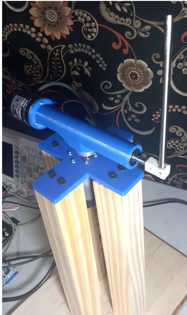
Figura 20: Modelo real del péndulo rotatorio V4.
