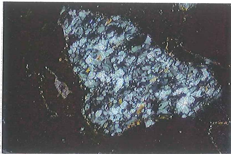
Figura 21. Clasto de un lítico metamórfico (Lm), posiblemente un gneis cuarzofeldespático. Se reconocen por la orientación de los cristales (foliación) y la presencia de minerales metamórficos (silimanita, kianita y micas). Luz polarizada, 10X. Pozo PZ-10 a 101-104 m.
