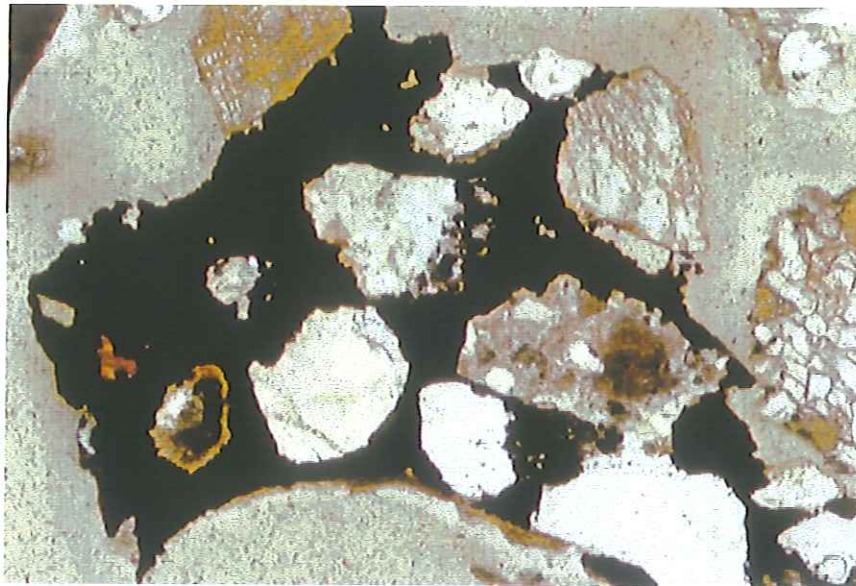
Figura 11. Cementante opaco (¿pirita?) en un fragmento de arenisca con clastos de cuarzo, feldespato, plagioclasas y pedernal. Luz paralela, 5X. Pozo I-4 a 104 m.
