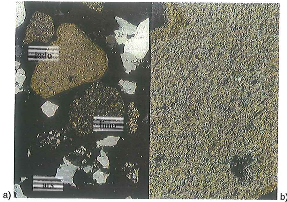
Figura 7. a) Fragmento de lodolita (lodo), limolita (limo) y arenisca (ars). Estos fragmentos originalmente fueron contados como Ls, sin embargo, pueden ser producto de la barrenación en sedimentos. El factor de corrección se obtuvo contando los líticos sedimentarios incluidos en recortes cementados por calcita o sílice. Luz polarizada, 2.5X. b) Detalle del fragmento de lodolita que presenta una matriz recrystalizada de micrita. Pozo Q-757 a 495 m. Luz polarizada, 10X.
