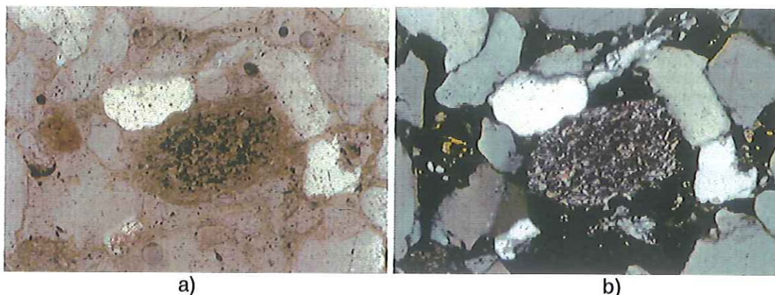
Figura 18. a) Clasto de plagioclasa alterada a sericita. Alrededor se observa cuarzo recristalizado con contactos suturados entre granos. Luz paralela, 10X. b) Misma microfotografía con luz polarizada. Pozo Q-757, núcleo a 831-840 m.
