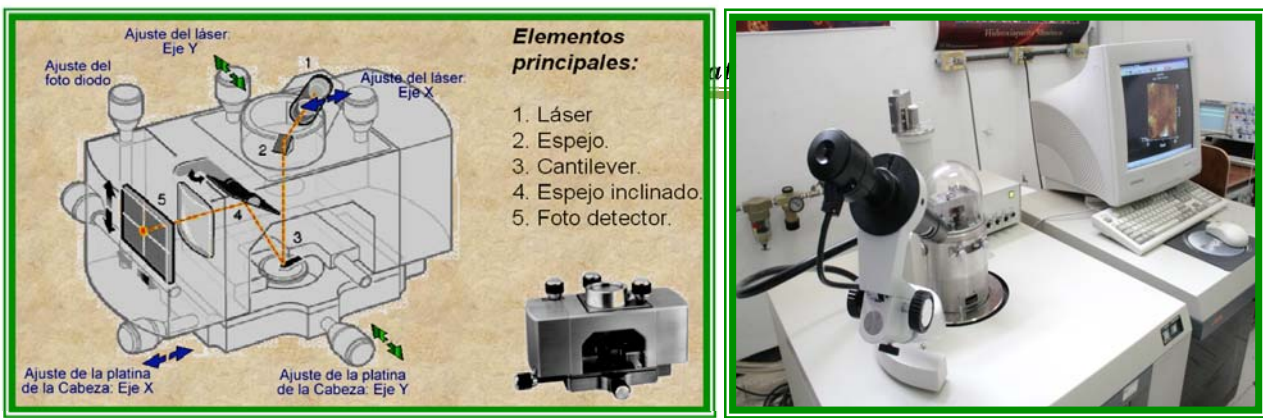
Figura 24 y 25. Funcionamiento del microscopio de AFM y fotografía de AFM utilizado
