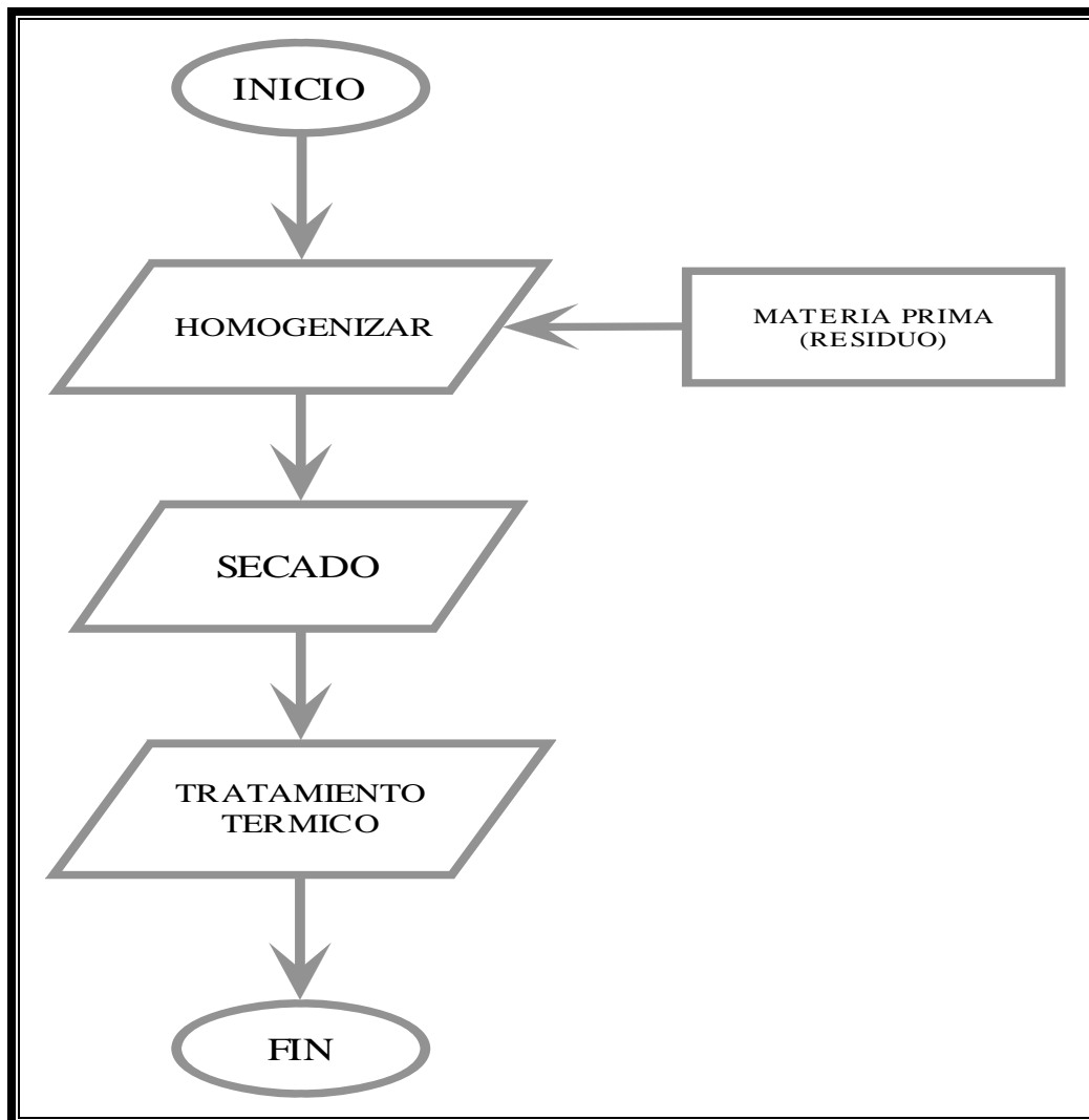
Figura 19. Diagrama de flujo del proceso para elaborar el material vitrocerámico.
