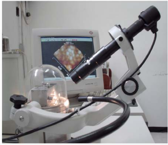
Figura 27. Funcionamiento real del microscopio de fuerza atómica
