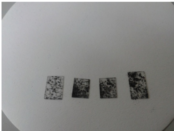
Figura 3.3. Tiras de prueba con nanopartículas de grafito.
