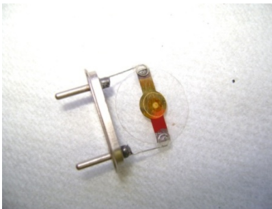
Figura 4.10. Microbalanza de cristal de cuarzo con sustrato adherido.
