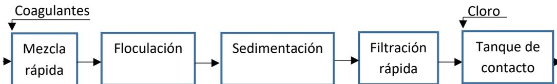
Figura 8. Tren de tratamiento de una planta convencional.
