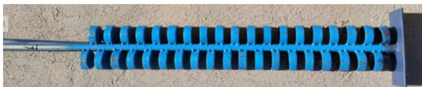
Figura 59. Medidor de expansión de medio filtrante.
