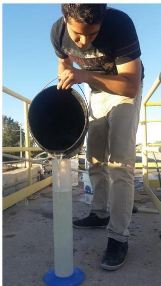
Figura 50. Aforo de bomba dosificadora.
