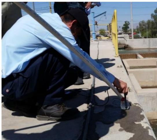
Figura 53. Medición de conductividad eléctrica.
