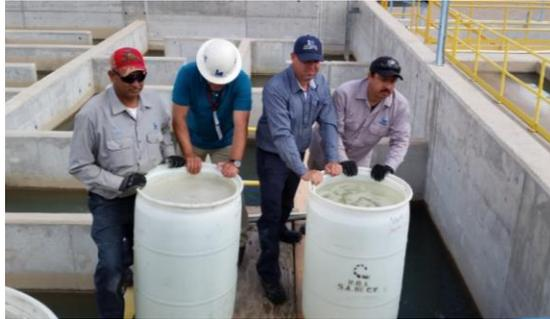
Figura 55. Adición de trazador.
