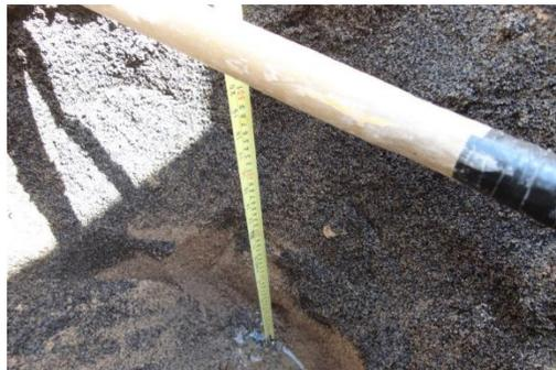
Figura 60. Medición del espesor del medio.
