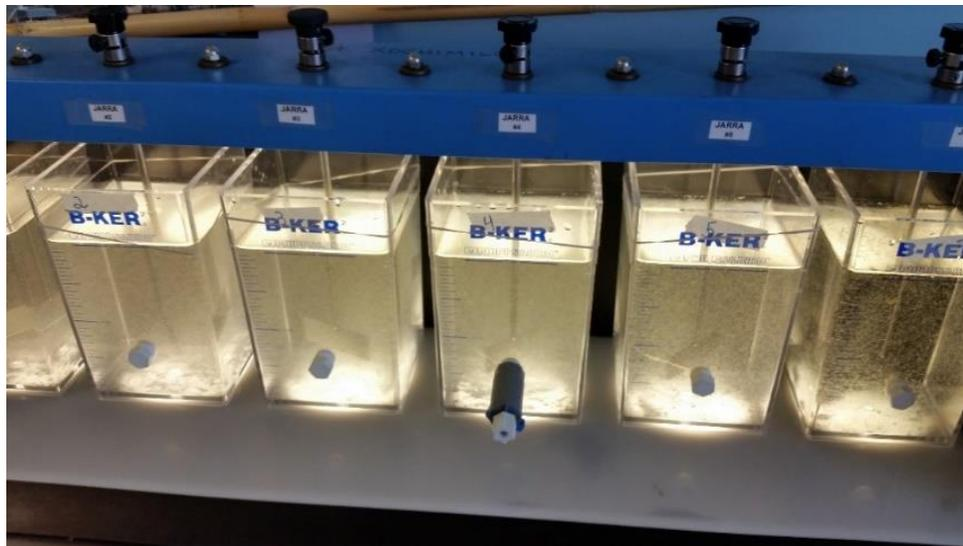
Figura 65. Prueba de jarras para determinación de dosis óptima de polímero.
