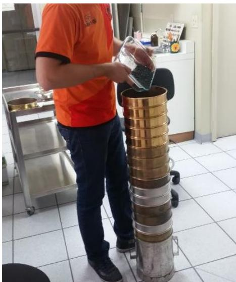
Figura 58. Adición de medio filtrante a juego de mallas.
