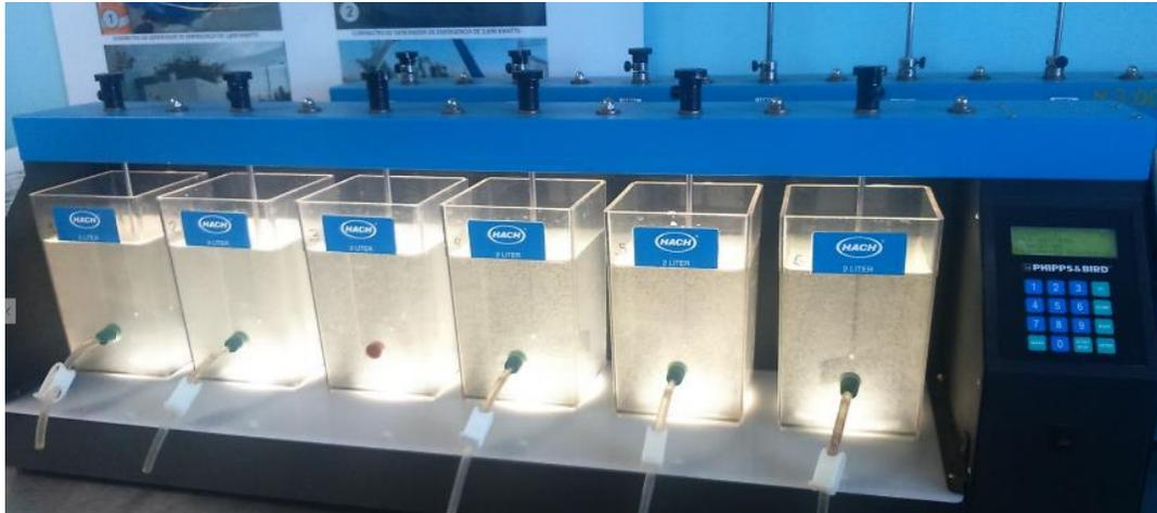
Figura 48. Prueba de jarras para determinación de dosis óptima de sulfato de aluminio.
