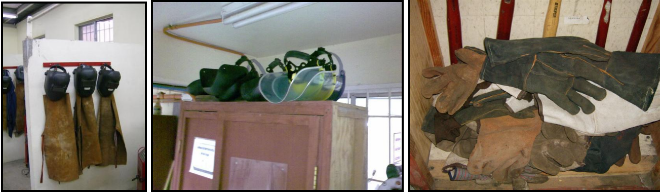
Figura 19 Equipo de protección personal del laboratorio de máquinas y herramientas
