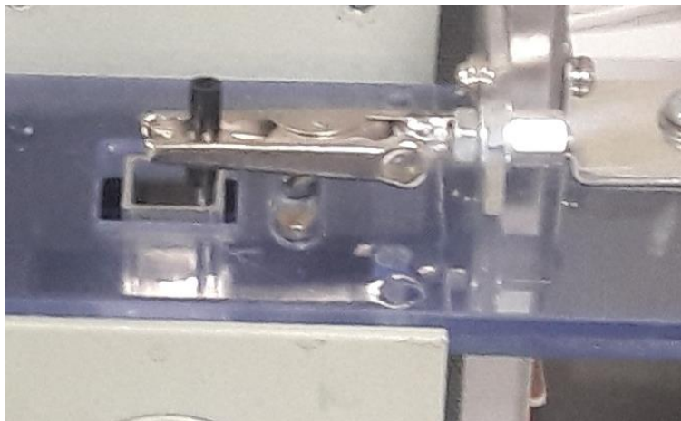
Figura 26. Inserción del pistón en la cubeta nefelométrica
