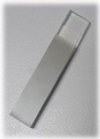
Figura 10. Tira desechable que sirve como bio-receptor
