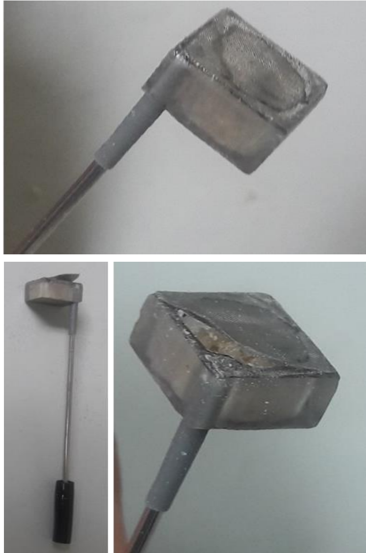
Figura 24. Preparación del pistón hueco
