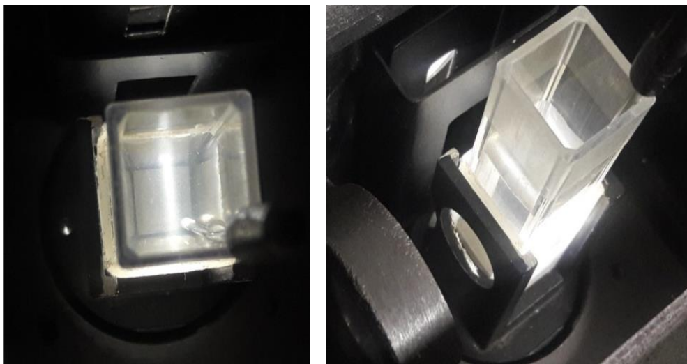
Figura 12. Fotografías de una cubeta nefelométrica
