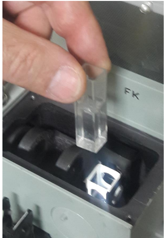
Figura 25. Cubeta nefelométrica. Preparación
