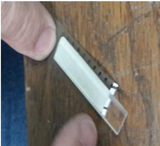
Figura 17. Aplicación de cinta fotográfica como capa sensible
