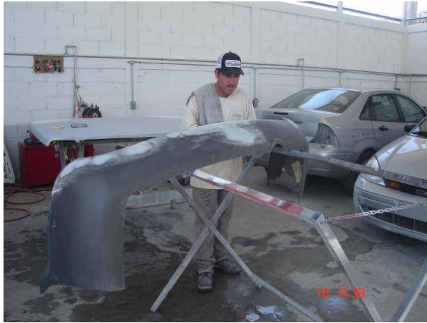
Foto 6. Aplicación de bondo a nivel piso, sin desagüe especial que conduzca los solventes y residuos.
