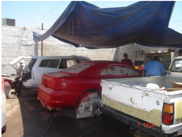
Foto 3. Área de pintado improvisada. Las condiciones de sombreado son precarias.
