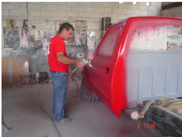
Foto 7. Pintor realizando la operación de pintura sin protección.
