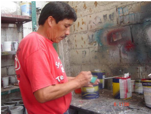
Foto 8. Preparación de pintura sin ningún tipo de protección.
