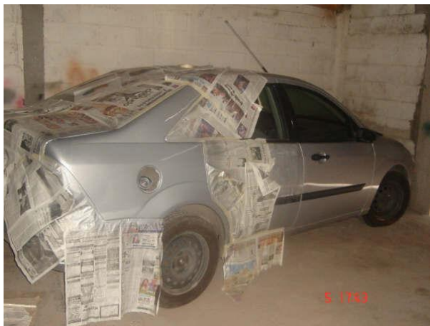
Foto 4. Cabina de pintado en un cuarto improvisado.
