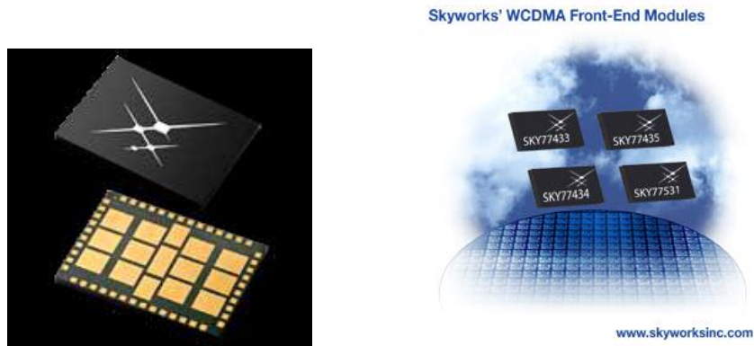
Figura 2-16: Paquetes tipo MCM (Cortesía Skyworks )
