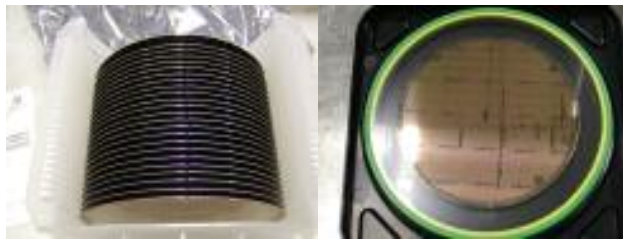
Figura 2-22: Circuitos integrados en forma de obleas: GaAs y Si (Cortesía Skyworks)
