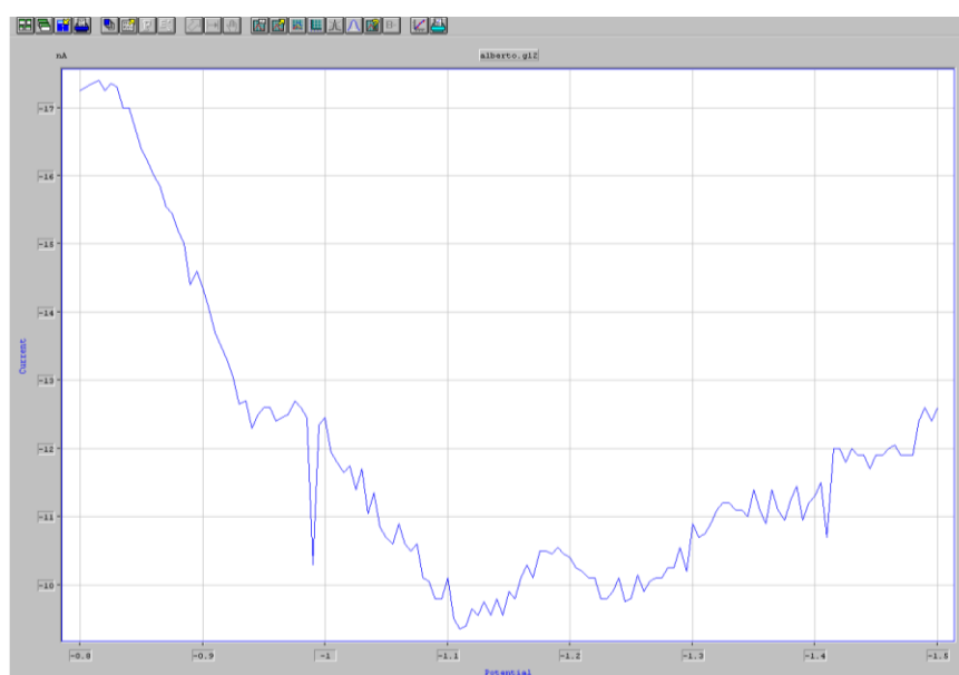
Figura 13. Voltamograma del electrolito tipo Watt después de agregar hidróxido de sodio ( \text{NaOH} ). Debido a la precipitación el pico de níquel ( \text{Ni}^{2+} ) desaparece.
