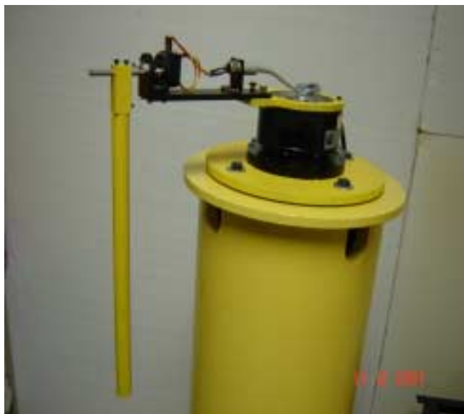
Figura 8: Péndulo de Furuta experimental.
