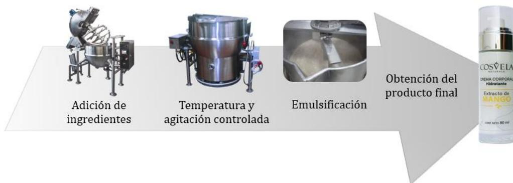
Se verifica la temperatura adecuada de trabajo para asegurar el estado líquido de los ingredientes. Considerando las características del equipo usado para el escalamiento, se realizaron pruebas a diferentes velocidades y tiempos, estableciendo como condición óptima 15000 rpm, se requiere dicha agitación para obtener la crema corporal con las características deseadas de una crema líquida.
