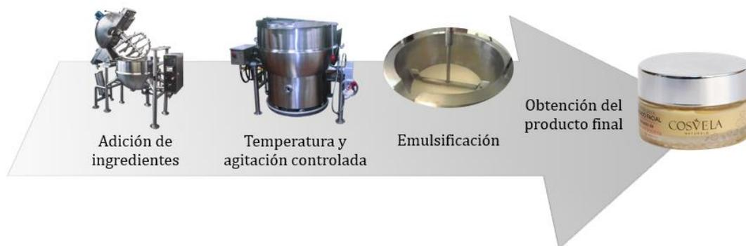
Se corrobora que la temperatura adecuada para la mezcla de los ingredientes, la temperatura establecida permite que todos los ingredientes se encuentren fundidos, considerando que el material con el punto de fusión más alto; no obstante, se establece la temperatura 5°C por encima de esta para asegurar la efectividad de esta etapa del proceso.
