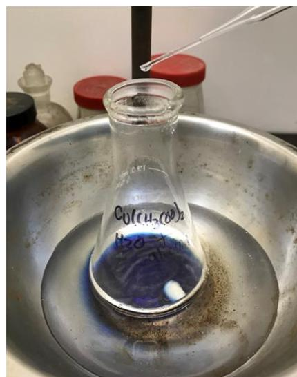
**Figura 17.** Goteo de solución de acetato de cobre en cada solución de aminoácido.
