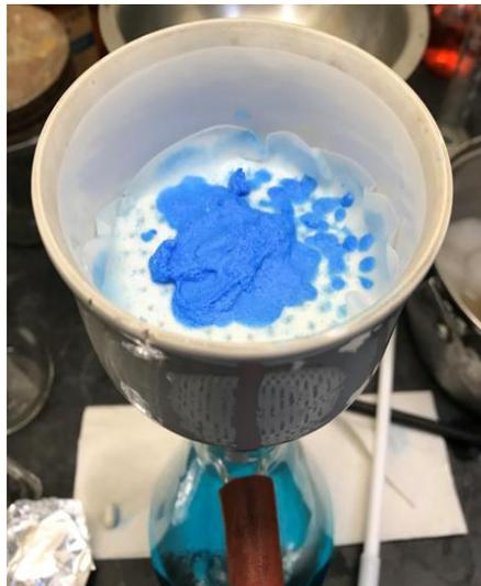
**Figura 21.** Filtración al vacío de los cristales obtenidos del baño de hielo.
