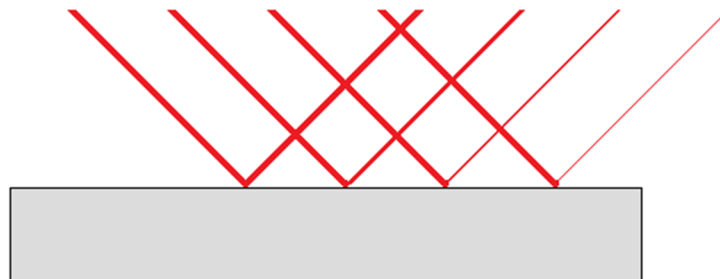
Figura 39. Absorción del láser por el cantiléver. La señal reflejada, es diferente dependiendo del punto en el que choca en el cantiléver.
