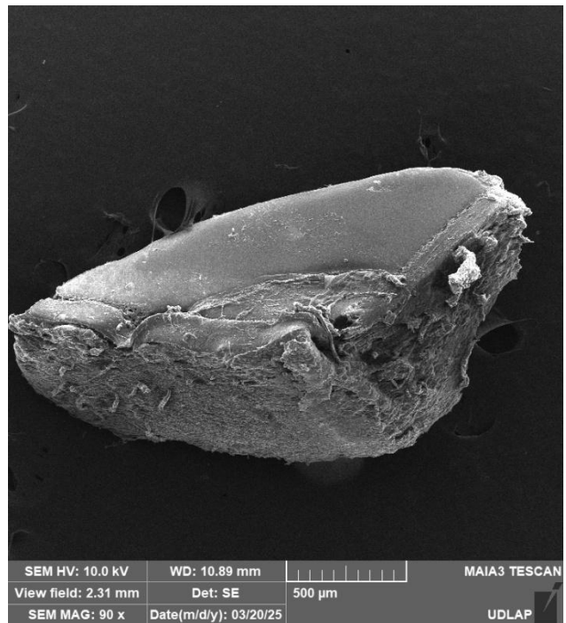
Figura 30. Micrografía SEM – 90 \times (campo de visión \approx 2.31 mm) Esta imagen de bajo aumento permite observar la forma general del fragmento polimérico, destacando una estructura compacta y sin poros visibles en el interior. El borde externo presenta rugosidades, probablemente formadas por fractura mecánica, mientras que el núcleo luce más denso. La muestra no muestra exfoliación evidente ni formación de capas separadas.
