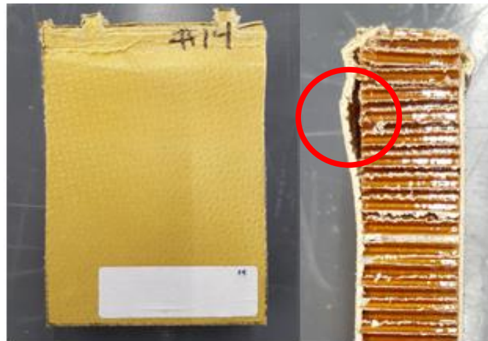
Fig. 63 Especímen 14 después de la prueba de CAI.
