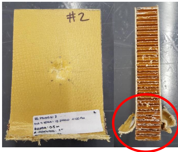
Fig. 66. Especimen 2 después de la prueba de CAI.
