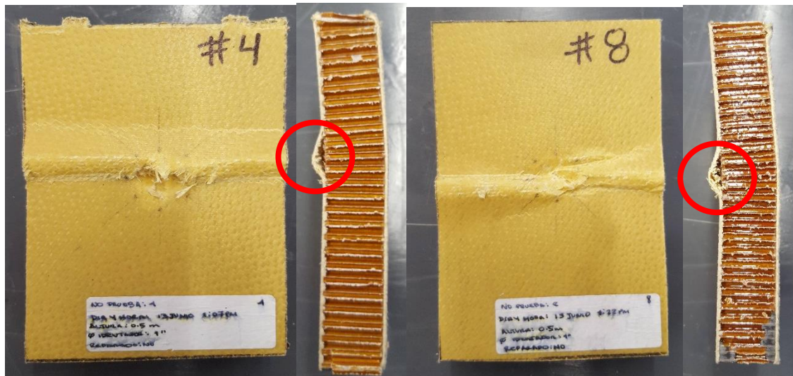
Fig. 67 Especímenes 4 y 8 después de la prueba de CAI.
