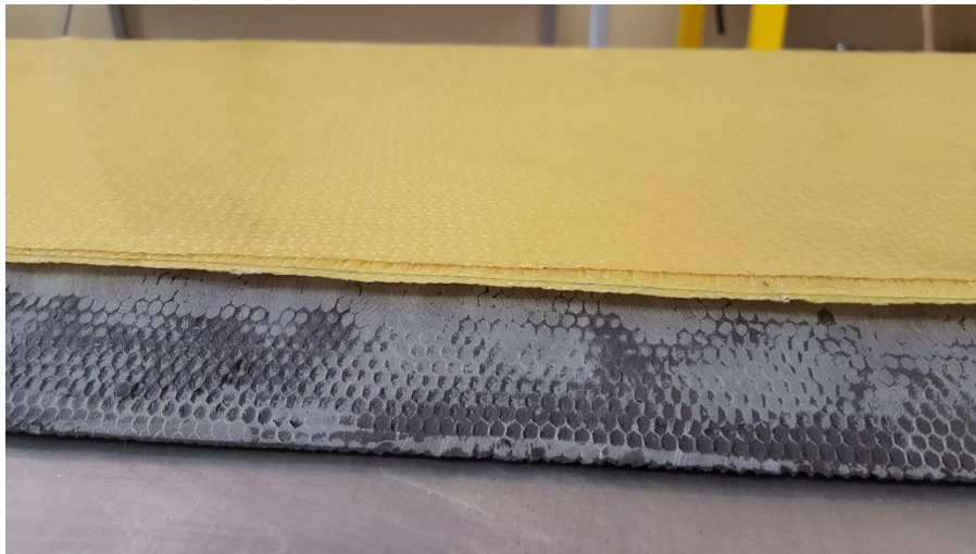
Fig. 40 Colocación del núcleo sobre el primer laminado y colocación de las 4 capas del laminado superior.
