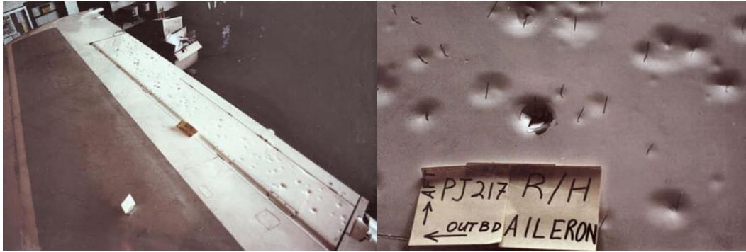
Fig. 5 Daño en alerón construido con material compuesto tipo sándwich [14].
