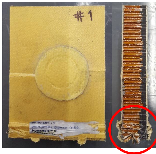
Fig. 69. Especímen 1 después de la prueba de CAI
