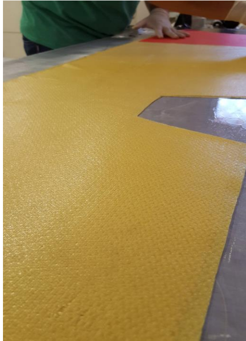
Fig. 39 Colocación de las capas del primer laminado sobre la placa de aluminio.
