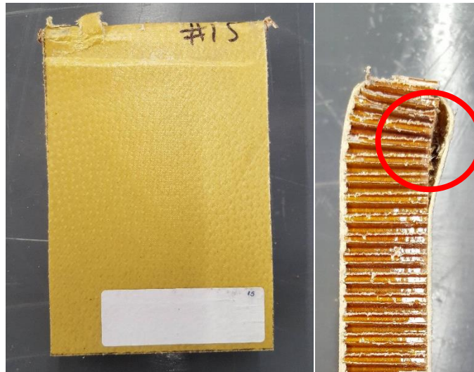
Fig. 64 Espécimen 15 después de la prueba de CAI.
