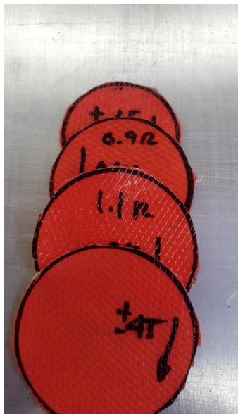
Fig. 52 Fibras recortadas para la reparación del laminado dañado.
