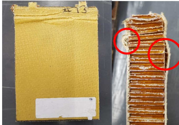
Fig. 62. Especímen 13 después de la prueba de CAI.
