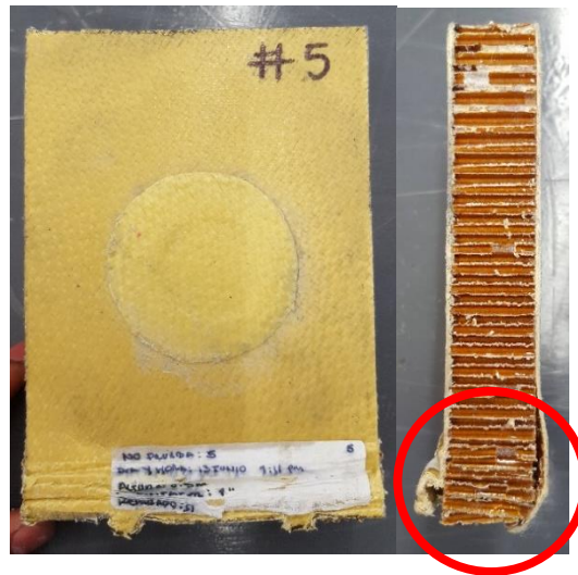
Fig. 70 Especímen 5 después de la prueba de CAI.
