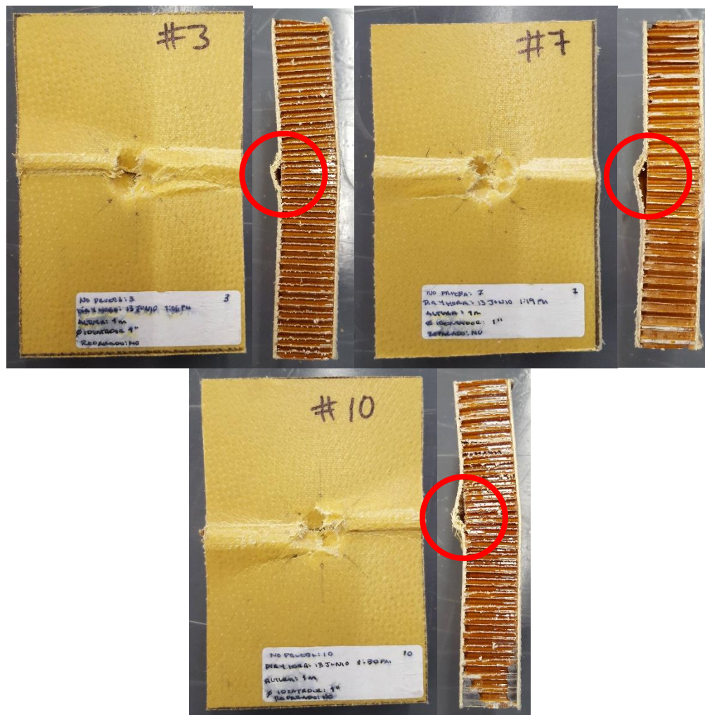
Fig. 73 Especímenes 3, 7 y 10 después de la prueba de CAI, se observa una similitud en su modo de falla.
