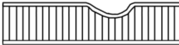
Fig. 28 Abolladura en la estructura tipo Sándwich [61].
