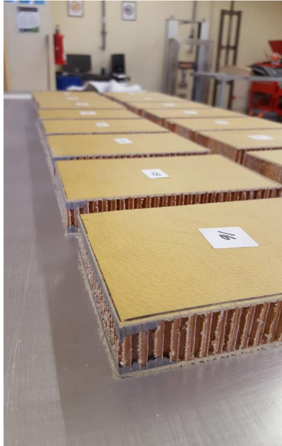
Fig. 43 Especímenes terminados conforme a las especificaciones de fabricación y dimensionamiento en base a la norma ASTM D7766.
