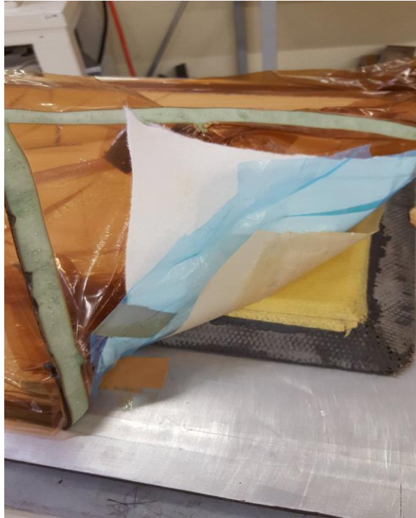
Fig. 41 Se muestran las capas que son colocadas para el proceso de embolsado: 1) Release film (café), 2) perforated film (azul), 3) bleeder (blanco), 4) bolsa de vacío (café oscuro).
