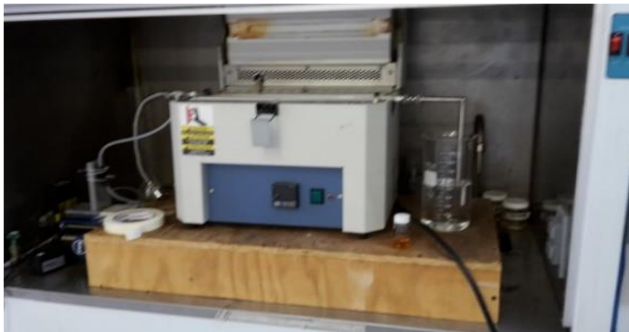
Figura 12. Sistema para la síntesis de Nanotubos de carbono de multipared.
