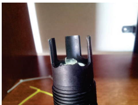
Figura 106: Sensor de pH dañado por golpe físico.
