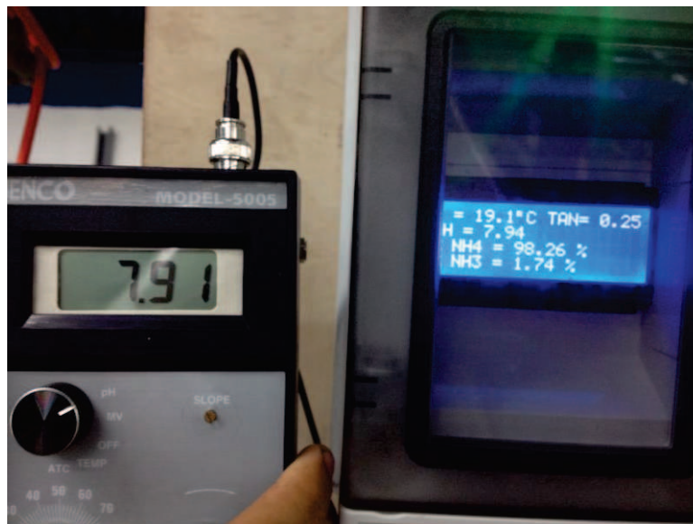
Figura 92: Comparación del sistema de pH obtenido versus uno comercial.
