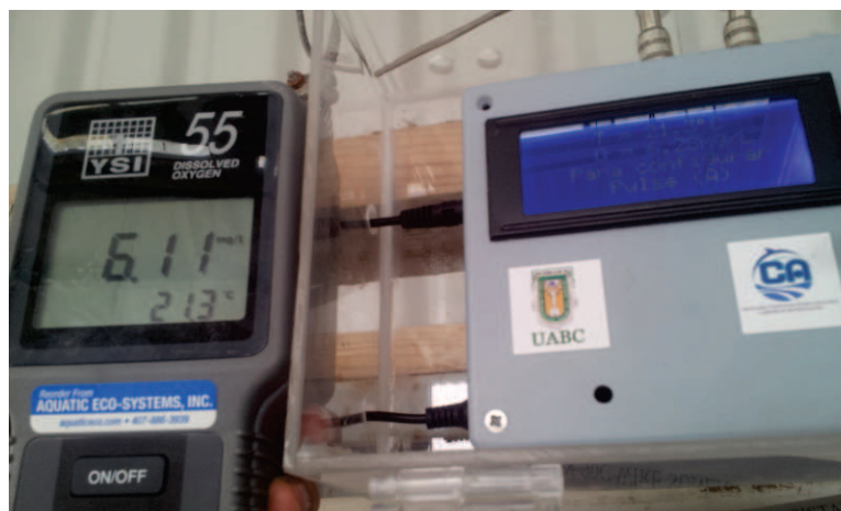
Figura 91: Comparación del sistema de oxígeno disuelto obtenido versus uno comercial.
