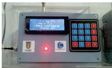
Figura 84: Tercer prototipo utilizado de medición de pH y temperatura, para medición de tanque principal de bombeo de agua.
