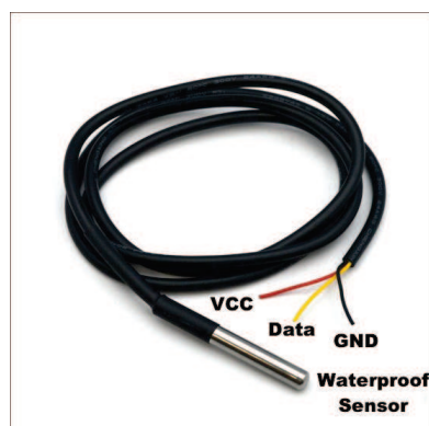
Figura 50: Sensor de temperatura DS18B20 con protección para el agua. Recuperado de Sensor DS18B20 [Online] (20 de Mayo de 2011).
