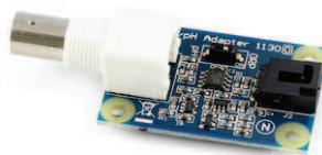
Figura 28: Adaptador de sensor de pH para microcontrolador, fabricado por la compañía Phidgets.
