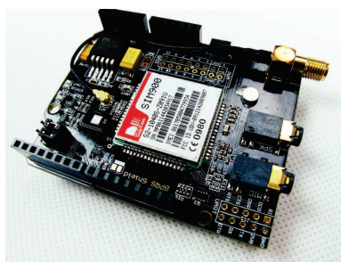
Figura 64: Módulo GSM shield. Recuperado de GSM Shield [Online] (20 de Mayo de 2011).
