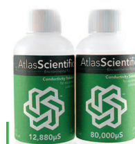
Figura 34: Buffer utilizados para calibración del sensor de conductividad. Recuperado de Buffer para circuito EZO [Online] (20 de Mayo de 2011).
