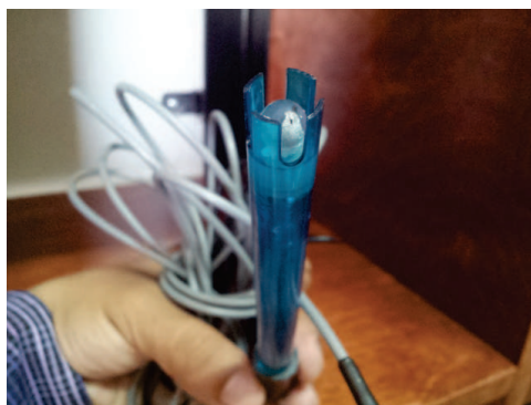
Figura 105: Sensor de pH con formación de sarro y KCL.
