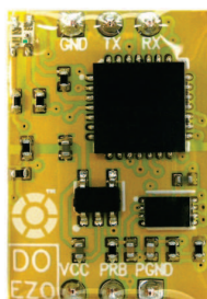
Figura 38: Circuito EZO para sensor de oxígeno disuelto. Recuperado de Hoja de datos circuito EZO para DO [Online] (20 de Mayo de 2011).
