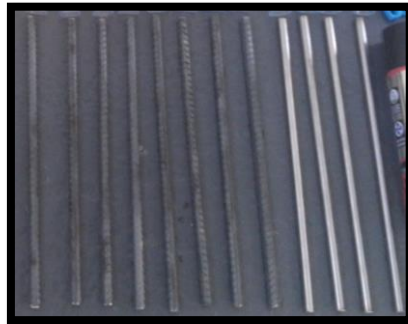
Figura 11.- Tramos 30 cm de varilla corrugada de acero al carbono y acero inoxidable
