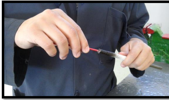
Figura 16.- Introducción del cable a la varilla
