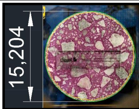
Imagen B.1.6 Levantamiento de profundidad de carbonatación de espécimen
