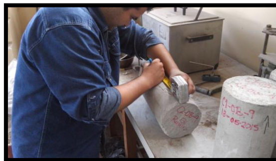
Figura 33.- Medición del corte del espécimen EC
