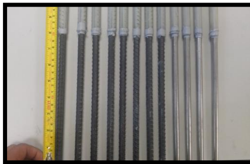
Figura 23.- Varilla de acero inoxidable con preparación especial
