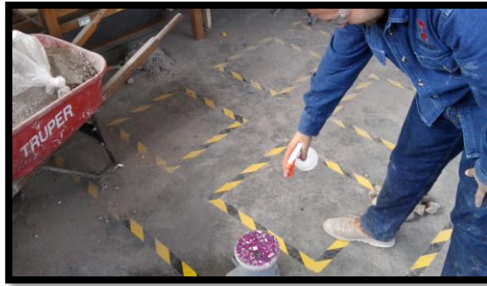
Figura 37.- Aplicación del indicador fenolftaleína la cara interna del corte
