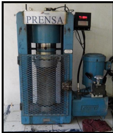
Figura 32.- Ensay de resistencia a la compresión de especímenes EC
