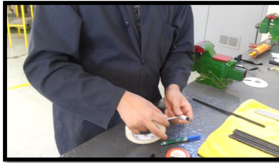
Figura 13.- Protección de la parte de debajo de la varilla
