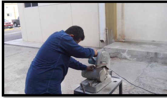
Figura 34.- Corte en seco del espécimen EC
