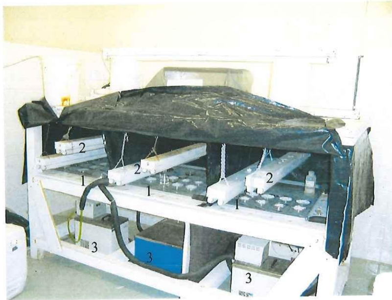
Fig. 2. Diseño experimental de la mesa de gradientes. Se observan las placas de aluminio (1), las lámparas de luz fría (2) y los termocirculadores (3) (Yarish et al. , 1979 y Zertuche-González, 1989).
