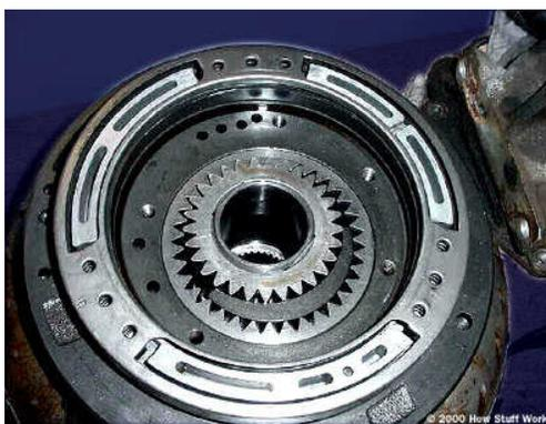
Figura 1.15 Bomba hidráulica de engranes
