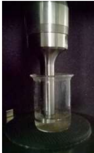
Figura 4.25 Tratamiento ultrasónico de la biomasa Streptomyces Fradiae .
