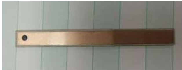
Figura 4.29. Foto del electrodo desechable elaborado por la tecnología PCB.
