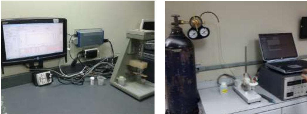
Figura 3.1. Fotos de los equipos aplicados en todos los experimentos: Potenciostato; Electrodo de tipo HMDE y solidos desechables con celda de 10 mL y computadora.
