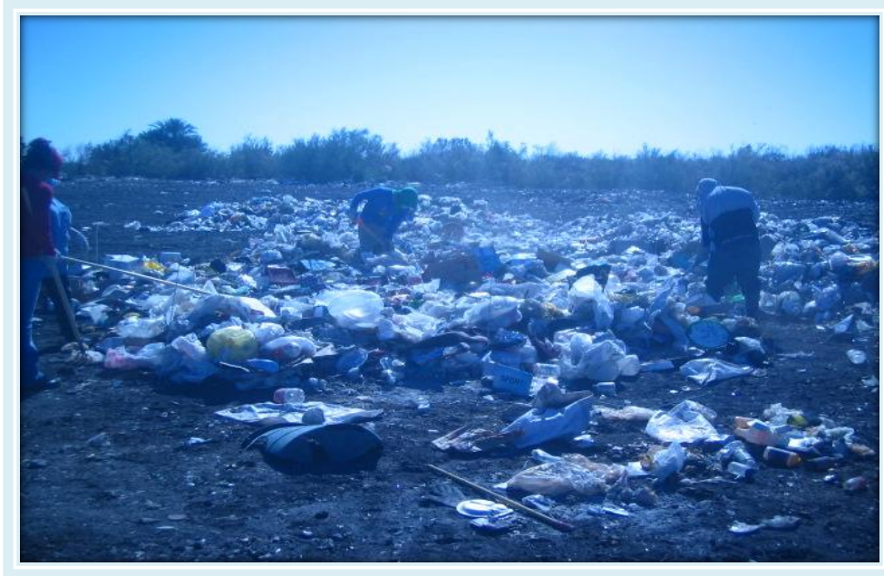
Figura A-5. Empleo del método de cuarteo para la caracterización de los residuos sólidos dispuestos en el área de estudio (marzo-2008)
