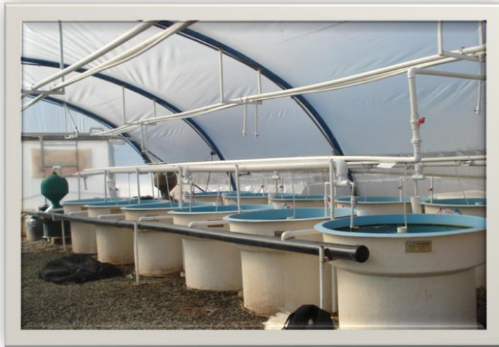
Figura 1.- Unidades experimentales en recirculación con una capacidad de 500L.
