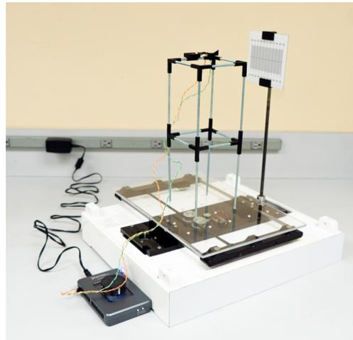
FIGURA 4.15: Mesa Vibradora y Estructura con la IMU. Esta estructura permite al sistema realizar los desplazamientos que puedan ser suficientemente grandes para poder ser medidos y diferenciar cada uno de los resultados.
