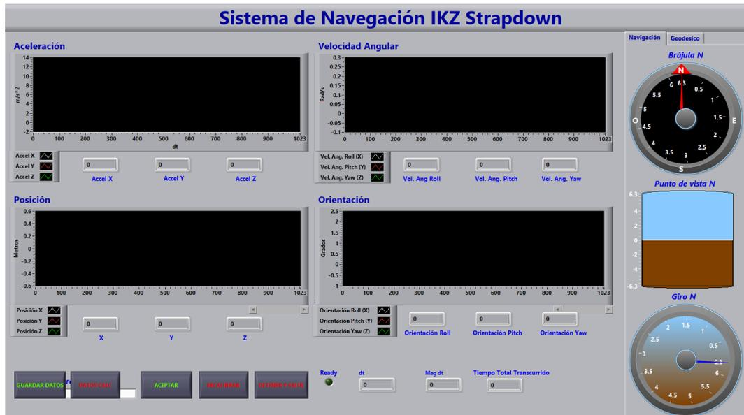
FIGURA 4.5: Panel Frontal del Instrumento Virtual en LabVIEW. Aquí se muestran las mediciones de Aceleración, Velocidad Angular, Orientación, Posición y Rumbo Magnético.
