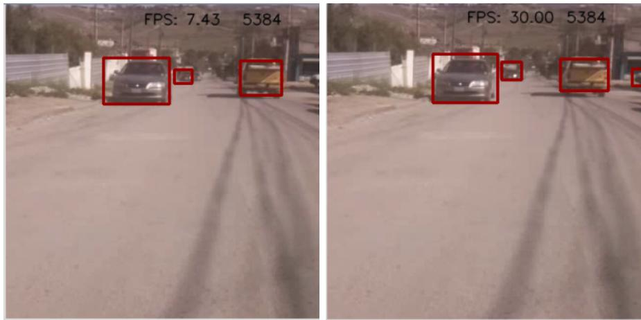
(a) Sistema en el CPU a 7.42fps. (b) Sistema con ayuda del TPU a 30fps.
