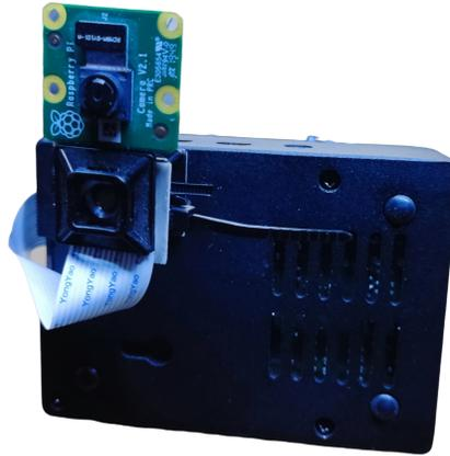
Figure 3.4: Cámara conectada al puerto CSI-2 del RPI4.
