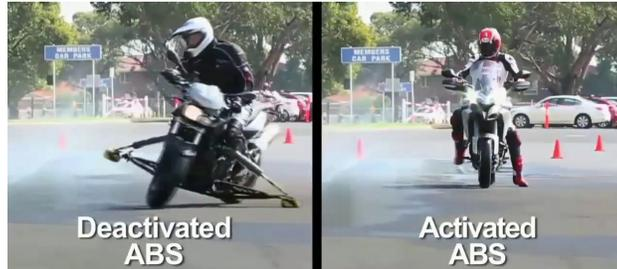
Figure 2.1: Sistema anti-bloqueo de frenos en funcionamiento.
