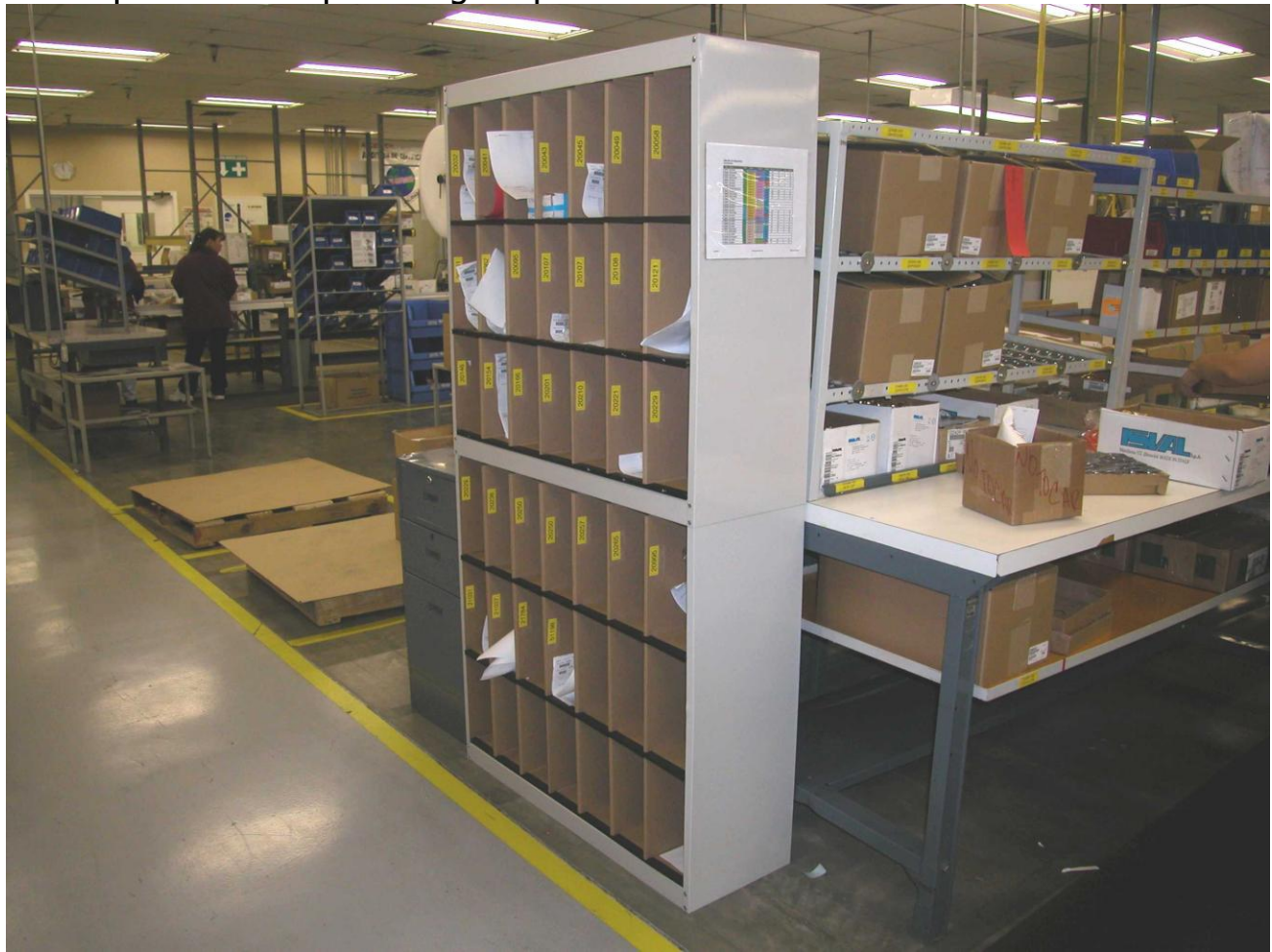
Fig. 4.1 Estante para control con kanban de placas de identificación en celda Kanban 8210
