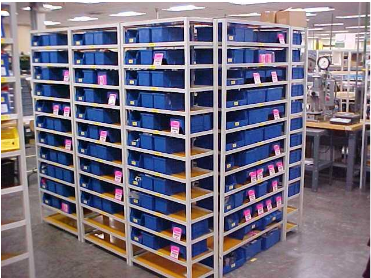
Fig. 4.2 Estantes para control con kanban del supermercado de sub. ensambles
