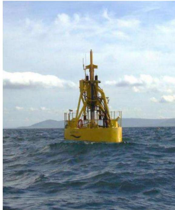
Figura 8. Imagen y esquema del dispositivo *Wavebob*. Se observan las dimensiones y partes del sistema, así como un dispositivo a escala 1:4 en funcionamiento en la Bahía de Galway, Irlanda (Mouwen, 2008; Weber et al., 2014).
