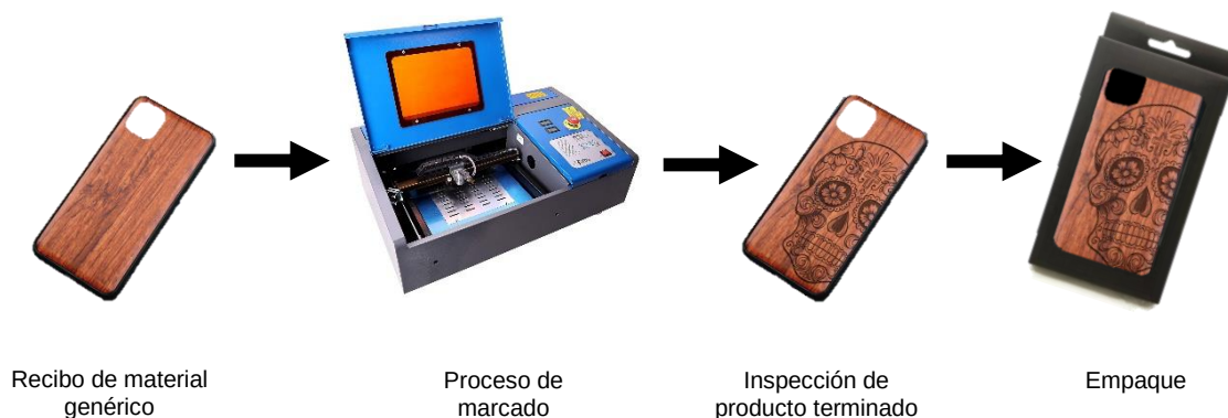
Imagen 20. Unidades de transformación.
